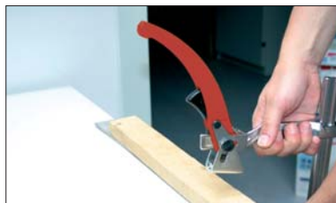
Durch einfaches Betätigen der Entriegelung lässt sich die Schraubzwinde lösen.
