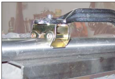
Optimal zum Spannen von Rohren bis 120 mm Durchmesser
