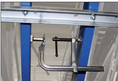
Schneller und einfacher Umbau zur Spreizzwinde
