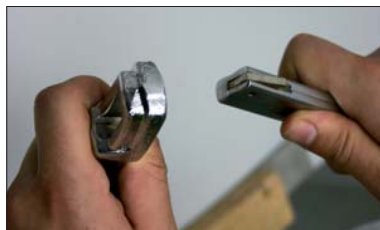
Einfacher Umbau der Spannschiene für Spreizanwendungen in zwei Schritten: Sicherungsknopf drücken und die Schiene lösen.
