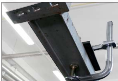
Übergreifen von T- und Doppel-T-Trägern und Profilen
