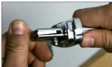
Einfacher Umbau der Spannschiene für Spreizanwendungen in zwei Schritten: Sicherungsknopf drücken und die Schiene lösen.
