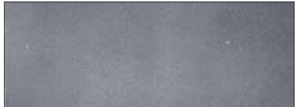
Einwandfreie Oberfläche bei 2.000 Stunden Salznebelbelastung eines mit Zink-Repair-„Premium“-Spray grundierten Bleches
