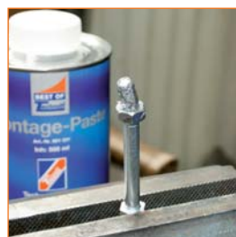
1. Zerstorertes Gewinde oder verbogene Stehbolzen...
