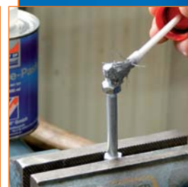
2. ... mit Technolit® Montagepaste satt einstreichen.
